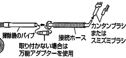
専用ブラシ以外のものを使用すると金属部(熱交換器)などの破損の原因となりますのでご使用をおやめください。
