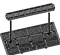
エアフィルターの爪部を室内機に確実にはめ、取付ける。
