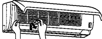
アレル・除菌フィルターの格子側を上にして、エアフィルターに押込むように10ヵ所の爪部を掛ける。
