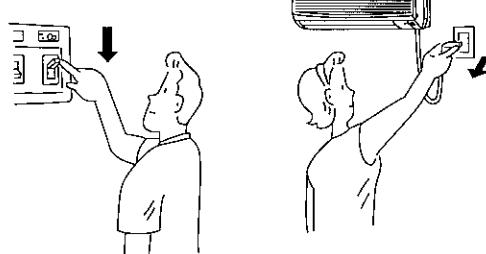
■液漏れによる故障をさけるためにリモコンから乾電池を取り出す。
