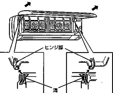
■丸洗いパネルは無理に引抜いたり、落下させない。丸洗いパネル破損の原因になります。
