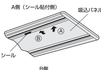
注) このとき吸込パネルは自重によってB側を支点に回転しますので吸込パネルを開けるときは注意してください。
