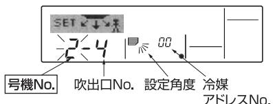
【手順③】…「冷媒アドレスNo.」を次のNo.にして確認します。(冷媒アドレスの最大はNo.15です)
