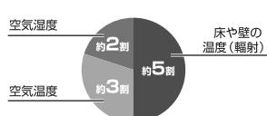
■床からの赤外線をとらえて、床温（輻射）を検知。室温と床温を測ることにより、人の感じる温度（体感温度）を演算し、冷やしすぎ、暖めすぎを防止します。
