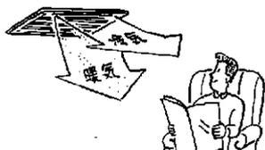
**風上下**、**風上下2** 自動では冷房運転は水平吹出し、暖房運転は下吹出し
