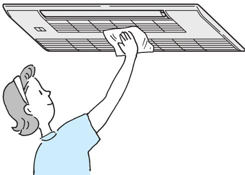
▶ ガソリン・ベンジン・シンナー・磨き粉は製品を傷めますので、使わないでください。
