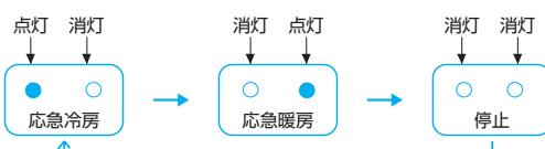
**停止するときは応急運転スイッチを押して「停止」にする。**
