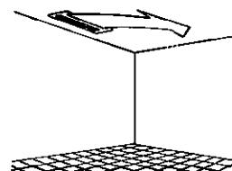
運転開始時、吹出し空気温度が低いとき、または霜取運転時は水平吹出しになります。
