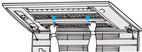
2 取外したカテキンエアフィルターのホコリを掃除機で吸収するか、水洗いする。
