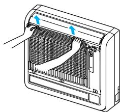
③ 室内機の取付部から両端の爪部に指を掛け、引っ張るようにアレル・除菌フィルターを取外す。
