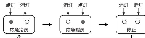
停止するときには応急運転スイッチを押して「停止」にする。
