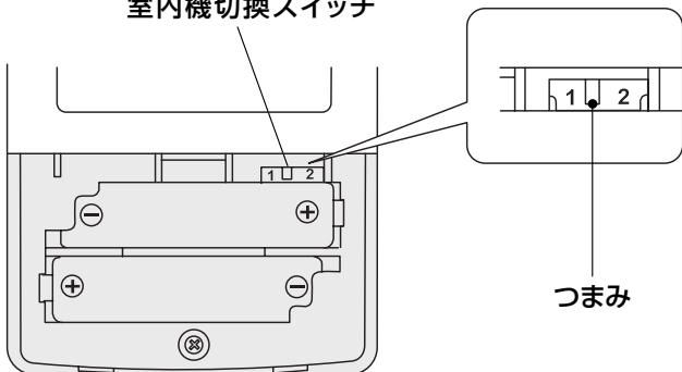
①裏ブタを引き抜き、乾電池を入れて裏ブタを取り付ける。
