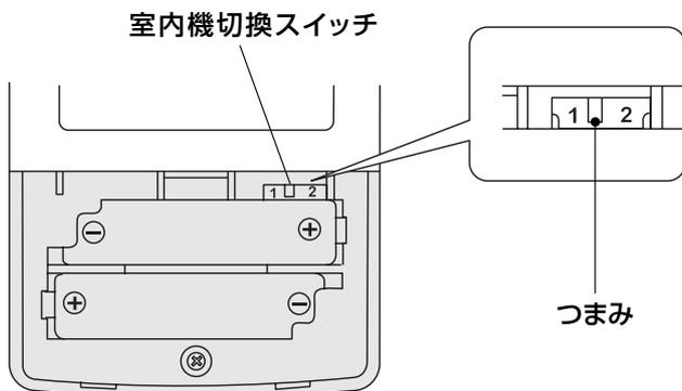
①裏ボタンを引き抜き、乾電池を入れて裏ボタンを取付ける。
