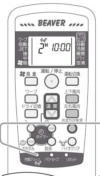
内部クリーン運転を設定すると、自動・冷房・愛情ドライ・お好みドライ運転の停止のあと、自動的に2時間内部クリーン運転を行います。室内ユニット内部の湿気を取り除き、カビ・細菌の成長を抑えます。
