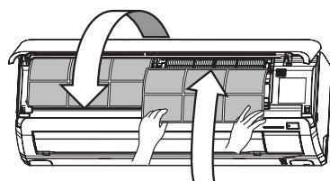
エアフィルターの両側を持ち、奥までしっかりと挿します。エアフィルターなしで運転すると故障の原因になります。
