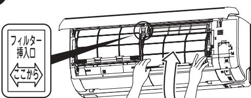
エアフィルターの両側を上図のように持ち、フィルター挿入口からエアフィルターを奥までしっかりと挿入します。
