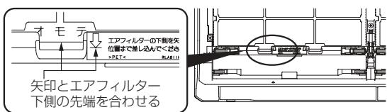
エアフィルター下側の先端がエアコン本体の矢印の位置まで挿入されていることを確認してください。エアフィルターの挿入が不十分だと、フィルター清掃運転が正しく動作しないことがあります。
