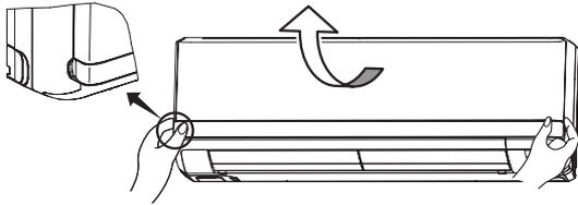
左右側面の凸部に手をかけ手前に引き上げると約60°開いた状態で静止します。それ以上引き上げるとパネルが外れることがあります。注意してください。
