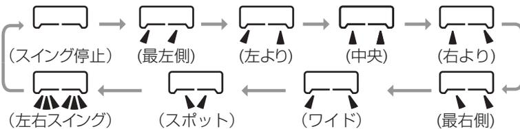
左右スイング中にスイングを停止した場合、停止した位置をマイコンが記憶します。次回運転時、ルーバは前回と同じ位置にセットします。(メモリールーバ機能)
