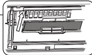
**5** エアフィルターを取付け、吸込パネルを閉じる ☞ 23ページ
