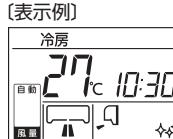
●チャイルドロックが設定されている場合は、温度・風量・風向などの各種設定の変更はできません。変更を行う場合は、チャイルドロックを解除してください。
