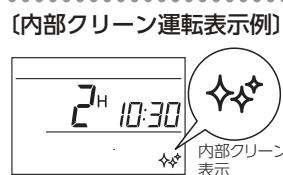
●自動・冷房・ドライ運転の場合は停止後、自動的に内部クリーン運転を約2時間行います。
