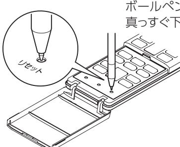
リセットスイッチを押すと時刻設定のモードとなるため、時刻を正しく合わせてください。
