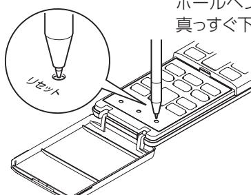
リセットスイッチを押すと時刻設定のモードとなるため、時刻を正しく合わせてください。
