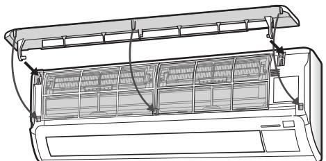
はめ込みが不十分ですと吸込パネルが破損する
