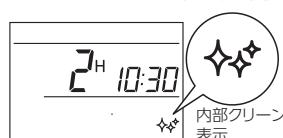
●自動・冷房・ドライ運転の場合は停止後、自動的に内部クリーン運転を約2時間行います。
