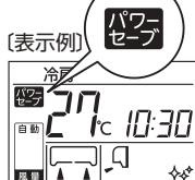
● パワーセーブ設定すると、最大冷・暖房能力が低下します。
