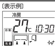
● チャイルドロックが設定されている場合は、温度・風量・風向などの各種設定の変更はできません。変更を行なう場合は、チャイルドロックを解除してください。
