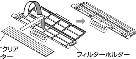
※バイオクリアフィルターはブリーツ(ひだ形状)が手前側になるように取り付けてください。
