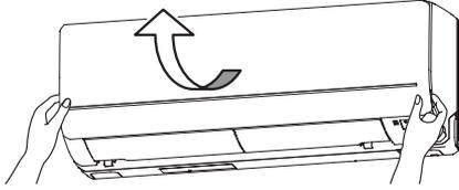
左右側面の凹部に手をかけ手前に引き上げますと約60°開いた状態で静止します。それ以上引き上げますとパネルが外れることがありますのでご注意ください。
