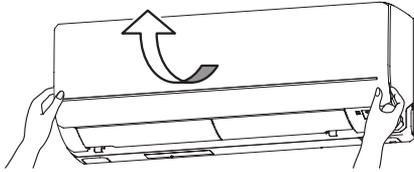
左右側面の凸部に手をかけ手前に引き上げると約60°開いた状態で静止します。それ以上引き上げるとパネルが外れることがあります。注意してください。
