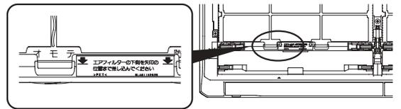
エアフィルター下側の先端がガイドの内側に挿入されていることを確認してください。エアフィルターの挿入が不十分だと、フィルター清掃運転が正しく動作しないことがあります。
