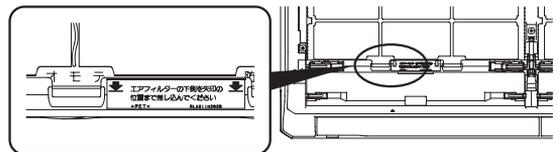
エアフィルター下側の先端がガイドの内側に挿入されていることを確認してください。エアフィルターの挿入が不十分だと、フィルター清掃運転が正しく動作しないことがあります。吸込パネルは左右そろえて軽く押したあと、中央部を軽く押さえてください。
