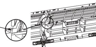
**5** エアフィルターを取付け、吸込パネルを閉じる
