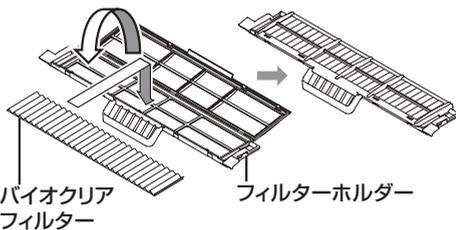
※バイオクリアフィルターはブリーツ(ひだ形状)が手前側になるように取り付けてください。
