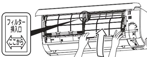
エアフィルターの両側を上図のように持ち、フィルター挿入口からエアフィルターを奥までしっかりと挿入します。エアフィルターなしで運転すると故障の原因になります。
