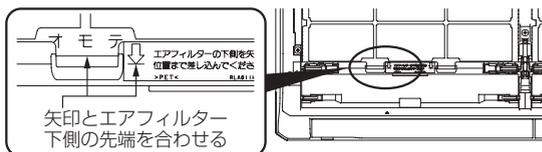
エアフィルター下側の先端がエアコン本体の矢印の位置まで挿入されていることを確認してください。エアフィルターの挿入が不十分だと、フィルター清掃運転が正しく動作しないことがあります。吸込パネルは左右そろえて軽く押したあと、中央部を軽く押さえてください。
