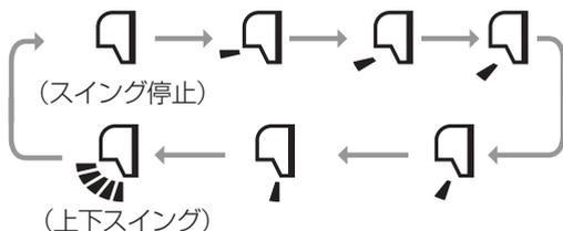
上下スイング中にスイングを停止した場合、停止した位置をマイコンが記憶します。次回運転時、フラップは前回と同じ位置にセットします。(メモリーフラップ機能)
