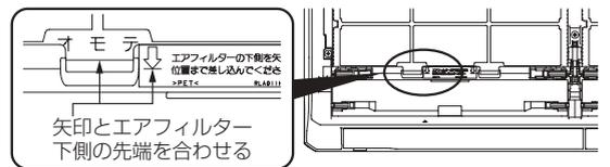
エアフィルター下側の先端がエアコン本体の矢印の位置まで挿入されていることを確認してください。エアフィルターの挿入が不十分だと、フィルター清掃運転が正しく動作しないことがあります。
