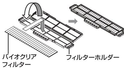
\*バイオクリアフィルターはプリーツ（ひだ形状）が手前側になるように取り付けてください。
