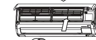
**4** フィルターを取り付けたフィルター ホルダーをエアコン本体に差し込み、取付ける
