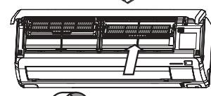
\* バイオクリアフィルターはプリーツ（ひだ形状）が手前側になるようにフィルター ホルダーに取り付けてください。
