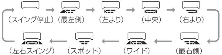
左右スイング中にスイングを停止した場合、停止した位置をマイコンが記憶します。次回運転時、ルーバは前回と同じ位置に自動的にセットします。(メモリールーバ機能)
