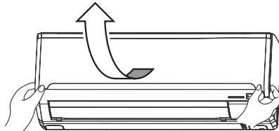
左右側面の凹部に手をかけ手前に引き上げますと約60°開いた状態で静止します。それ以上引き上げますとパネルが外れることがありますのでご注意ください。
