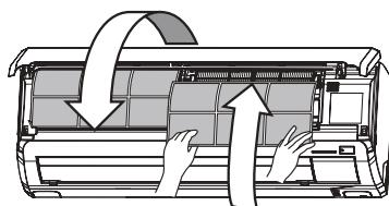
エアフィルターの両側を上図のように持ち、奥までしっかりと挿します。エアフィルターなしで運転すると故障の原因になります。
