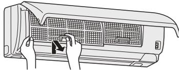
アレル・除菌フィルターの格子側を上にして、エアフィルターに押込むように10か所の爪部を掛ける。
