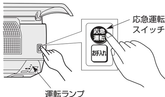
室内機の運転ランプを用いて運転内容を表示します。
