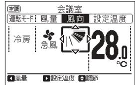
冷房およびドライ運転のときは55°～60°の位置で押しても、自動的に50°の位置に固定されます。
