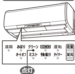
室内機のランプ表示
