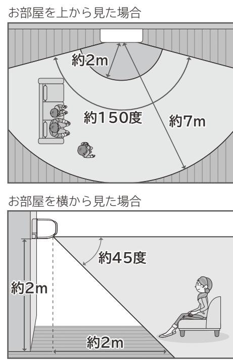
※温度カメラは天井の温度も検知します。
