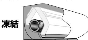
急速冷却で熱交換器に大量の霜をつける
