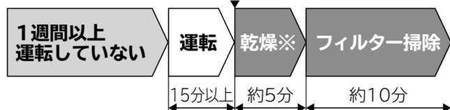
※冷房・カラッと除湿・涼快運転停止時のみ室内機内部を約5分間乾燥します。
