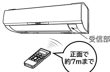
同じ部屋に2台の室内機を据え付けたときなどにリモコンの混信を防ぎたいときはアドレスを切り換えることができます
