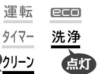
リモコンを操作してもクリーン運転ができないときは「ピピー」と鳴り、洗浄ランプが点滅します
