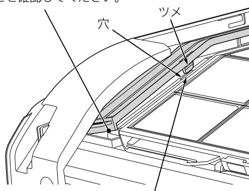
ホコリキャッチャーを押し付けることで、ホコリキャッチャーのツメが穴に入り、ホコリキャッチャーが固定されます。
