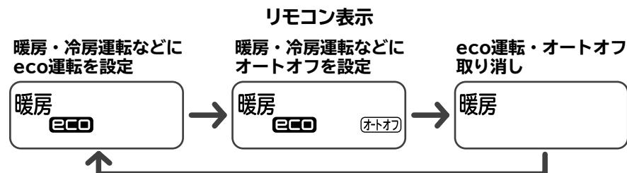
暖房・冷房運転などをeco運転を設定して運転を停止するとeco運転の設定は取り消されます。必要に応じてもう一度設定してください。
