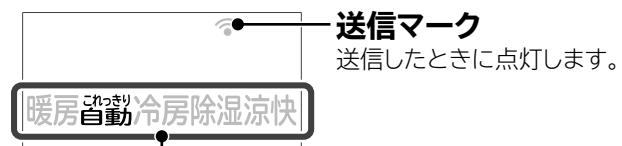
運転停止中は前回停止した運転の種類を表示します
