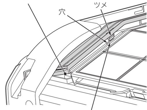
ホコリキャッチャーを押し付けることで、ホコリキャッチャーのツメが穴に入り、ホコリキャッチャーが固定されます。
