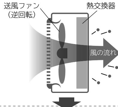
室外機のファン逆回転後、洗浄ランプが点灯します
