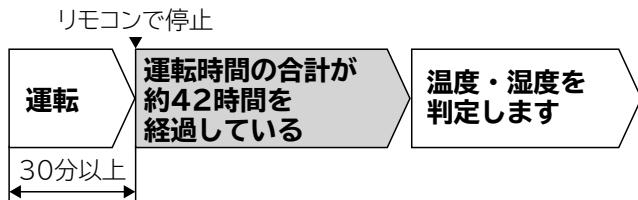
温度・湿度条件を満たしていると、洗浄ランプが点灯して約8分間送風したあと日差しがあるか検知します。
