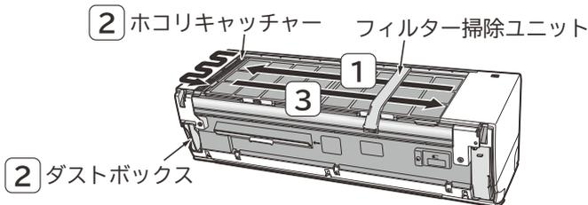
※左図は説明のため、フロントパネルを取り外した状態です。実際はフロントパネルを開けたり、取り外した状態では「フィルター掃除」運転を行わないでください。けがや故障の原因になります。
