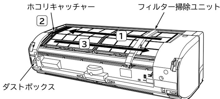
説明のため、フロントパネルを取り外しています。けがや故障の原因になりますので、フロントパネルを取り外したり、開けたままで、フィルターの掃除をしないでください。
