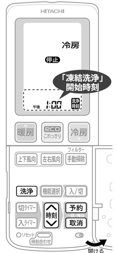
室内機の熱交換器を洗浄する(凍結洗浄)
