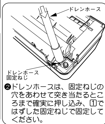
①ドレンホースは固定ねじをはずして、抜きます。
