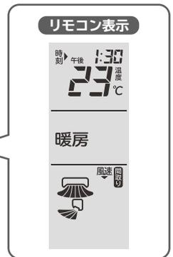
※ **間取り** の表示は設定後3秒間で消灯し、その後風速の設定が表示されます。
