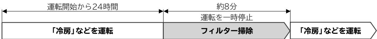
24時間過ぎるごとに運転を一時停止して、フィルターを掃除します。(フィルターを掃除する前の「乾燥」→P.23はしません)上下風向板は開いたまま、「クリーン」ランプが点灯します。フィルター掃除終了後、運転を再開します。
