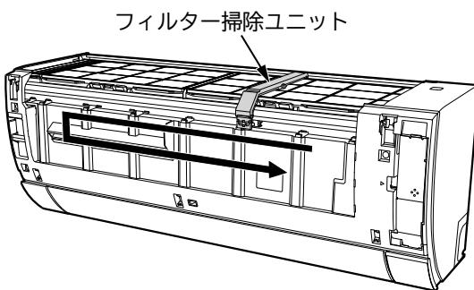
※イラストは説明のため、フロントパネルを取り外しています。けがや故障の原因になりますので、フィルター掃除ユニットが動作中は、フロントパネルを開けたり、取り外したりしないでください。
