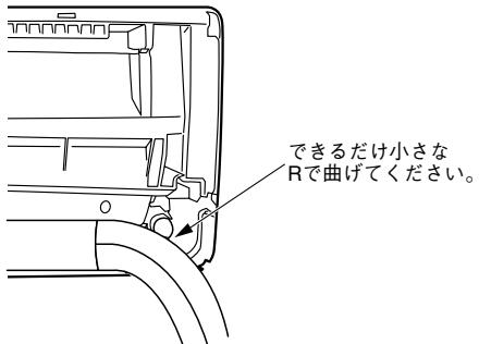
冷媒配管の曲げ始めが壁穴範囲から出でていたり、曲げRが大きいと、室内機が壁から浮き上がり、仕上りが悪くなる原因となります。
