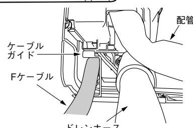
⑤Fケーブルを接続し、ケーブル固定バンドで固定します。
