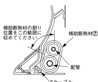
③冷媒配管を壁穴位置に合わせて整形します。
