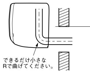
冷媒配管の曲げ始めが壁穴範囲から出ていたり、曲げRが大きいと、室内機が壁から浮き上がり、仕上りが悪くなる原因となります。
