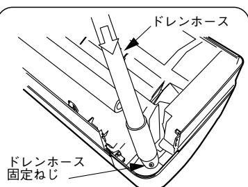
②ドレンホースは、固定ねじの穴をあわせて突き当たるところまで確実に押し込み、①ではずした固定ねじで固定してください。
