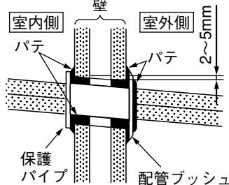
●保護パイプ(市販品)は必ず使用する接続ケーブルが壁の中のメタルラスに接触したり、壁が中空の場合、ねずみにかじられたりして感電や火災の原因となります。
