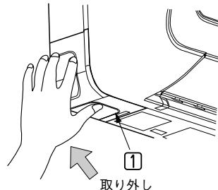
●取り付けは②部を先に取り付け、②部を支点として回転させて①部を取り付けます。
