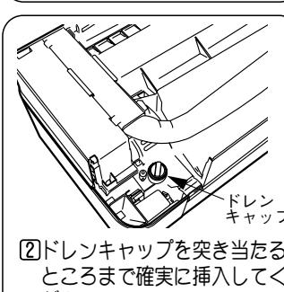
②ドレンキャップを突き当たるところまで確実に押し込み、①ではずした固定ねじで固定してください。
