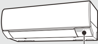
室内機のランプ表示
