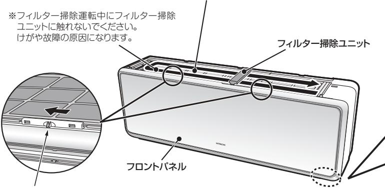
※エアフィルター(ステンレスフィルター)が確実に取付けられて、エアフィルターロックがロック側(左端)に固定されていることを確認してください。
