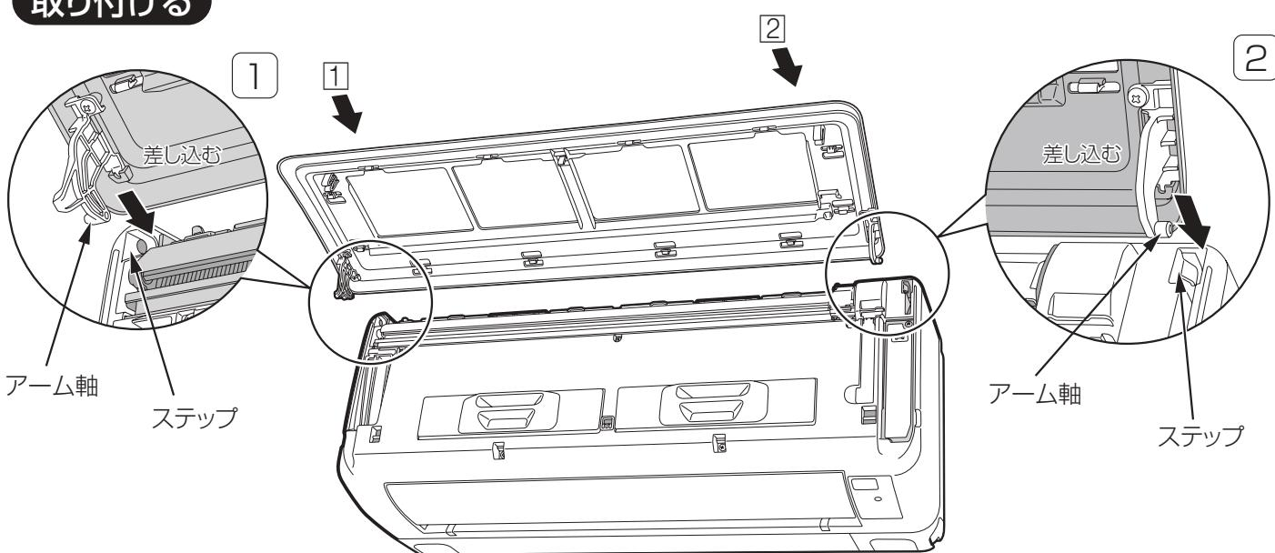
①先に左側のアームの軸をステップに沿わせて差込み、軸穴に入れます。
