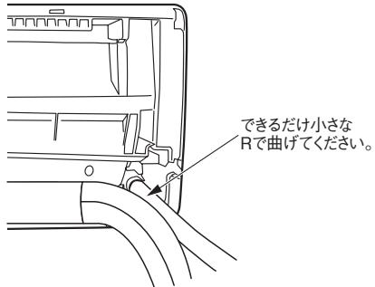
冷媒配管の曲げ始めが壁穴範囲から出でていたり、曲げRが大きいと、室内機が壁から浮き上がり、仕上りが悪くなる原因となります。
