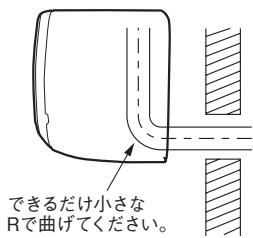
冷媒配管の曲げ始めが壁穴範囲から出でていたり、曲げRが大きいと、室内機が壁から浮き上がり、仕上りが悪くなる原因となります。
