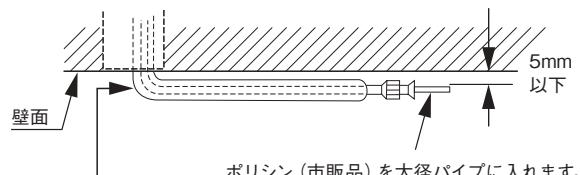
できるだけ小さなRで曲げてください。(ポリシンを使用すると配管を潰さずに小さなRで曲げることができます)
