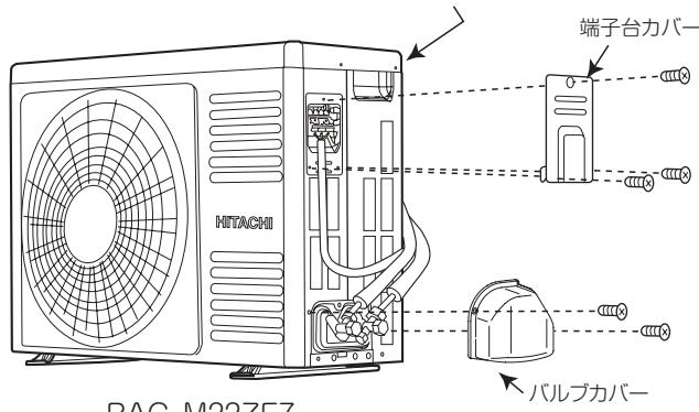
●側面カバーは取っ手を持ち、下方へずらして端部のフックをはずしてから引いてください。取り付けるときは、逆の手順で行います。
