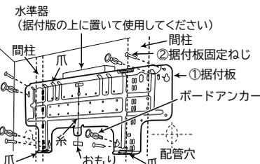
ねじ止めは、できるだけ室内機の爪をひっかける上下の爪の付近で行ってください。また、4本以上のねじで固定してください。
