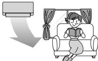
エアコンは、お部屋の空気を循環させて設定した温度や湿度にする仕組みです。室内機の吹き出し口や吸い込み口をカーテンや他の障害物でふさがないでください。
