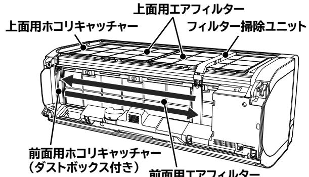
イラストは説明のため、フロントパネルを取り外しています。けがや故障の原因になりますので、フィルター掃除中はフロントパネルを開けたり、取り外したりしないでください。
