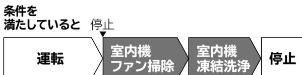
動作するタイミングが重なった場合は、フィルター掃除→室内機ファン掃除→室内機凍結洗浄の順に動作します。
