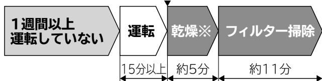
※冷房・カラッと除湿・涼快・eco除湿運転停止時のみエアフィルターを掃除する前に室内機内部を約5分間乾燥します。
