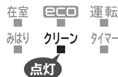
室内機のランプ表示
