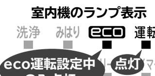
暖房・冷房運転などにeco運転を設定して運転を停止すると、eco運転の設定は取り消されます。必要に応じてもう一度設定してください。
