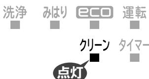
凍結洗淨と動作タイミングが重なったときは、クリーンランプと洗淨ランプが点灯します。
