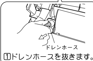
①ドレンキャップはペンチを使って回しながら抜きますと簡単に抜けます。
