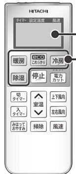
運転停止状態で、約3分間操作しないと節電のため液晶表示を消灯します。ボタンを押すと再表示します。
