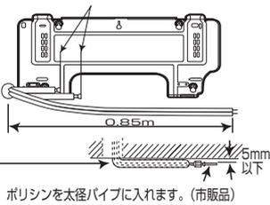
できるだけ小さなRで曲げてください。(ポリシンを使用すると配管を潰さずに小さなRで曲げることができます。)
