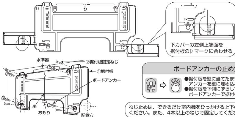
ねじ止めは、できるだけ室内機をひっかける上下の爪の付近で行ってください。また、4本以上のねじで固定してください。
