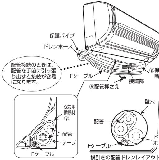
配管接続のときは、配管を手前に引っ張り出すと接続が容易になります。
