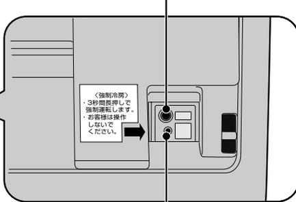
電池切れなどでリモコンが使えないとき応急運転スイッチを押すと応急運転を行います。応急運転は前回の運転内容で運転します。(但し、電源を入れた直後は自動運転を行います。)
