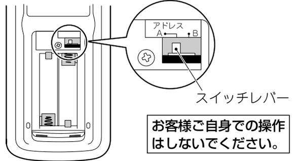
※アドレス切換スイッチは、2台の室内機を同じ部屋に据え付けたときなど、リモコンの混信を防ぎたいときに使用しますので、通常は使用しません。
