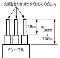
※80mm~100mmの寸法部は、移設時のFケーブル引き抜き作業時を考慮した寸法になっています。
