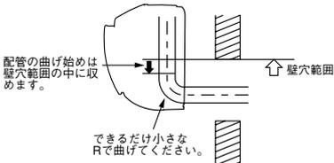
冷媒配管の曲げ始めが壁穴範囲から出ていたり、曲げRが大きいと、室内機が壁から浮き上がり、仕上がりが悪くなる原因となります。
