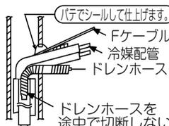
室内機のドレンホースは、室外機のバルブカバーへ導かないでください。使用条件により、バルブカバーより水垂れの恐れがあります。
