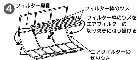
④ フィルター枠をエアフィルターの裏側に取り付ける
