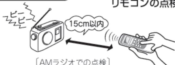
(AMラジオの電源を入れた状態で、リモコンを操作したとき、信号音(ピーピー音)が入れば正常です。)
