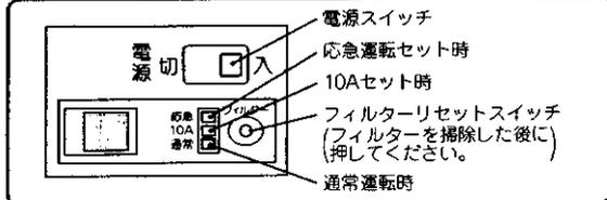
☆ご家庭のブレーカーが切れてしまうようなときに使います。スイッチを“10A”にセットしますと、ブレーカー切れが防ぎやすくなります。
