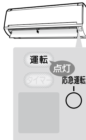
室内機のランプ表示
